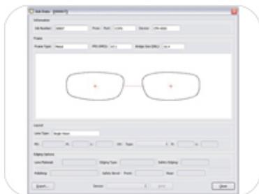
Todas as informações captadas na leitura da armação/lente juntamente com dados da receita (DP, altura, ponte aro, etc) são enviadas de forma remota pelo sistema HERA que transfere automaticamente estas informações para a biseladora.
