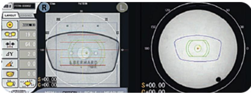
Função “**digital scanning**” para digitalização da lente, sem necessidade de uso do leitor 3D.
