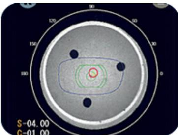
Lensômetro digital integrado, fornece valores esféricos, cilíndricos e eixos de qualquer tipo de lente. Sistema inteligente com câmera automática para reconhecimento do tipo de lente (visão simples, bifocal ou progressiva).
