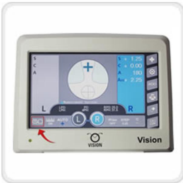
Sistema de reconhecimento automático do tipo da lente (progressiva ou visão simples). Evita erros do operador!
