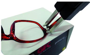
Auxilia na retirada de dobradiças quebradas em segundos e na recolocação de postigo.
